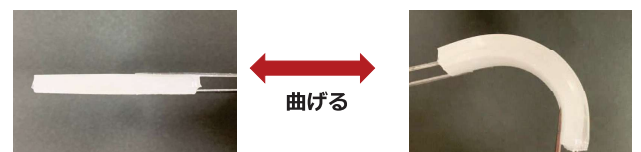
図6 多孔質スポンジ+ゲル状素材の基板
