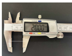
写真3 ミノムシ糸をノギスに固定し強度を測定する様子
