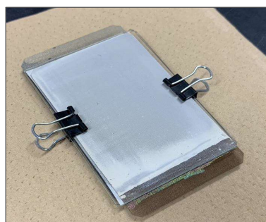
実際に作成した色素増感太陽電池の写真
