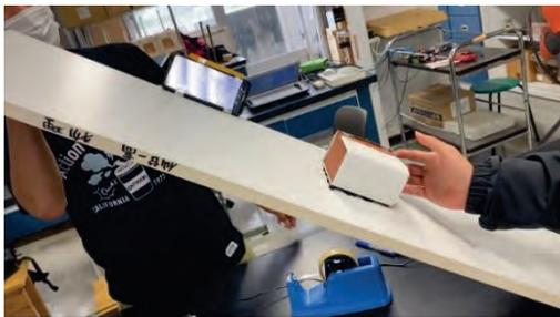
画用紙を巻いたおもりに各形(下図)の付属品を付け、板に乗せて角度を大きくする。滑り出した角度を計測し、 $\mu = \tan\theta$ を用いて静止摩擦係数を求める。
